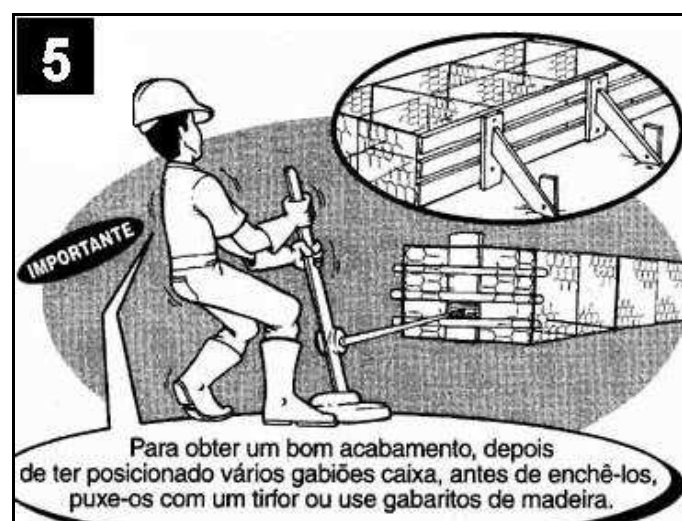
Figura 05 – Detalhe da utilização do tirfor ou gabarito
