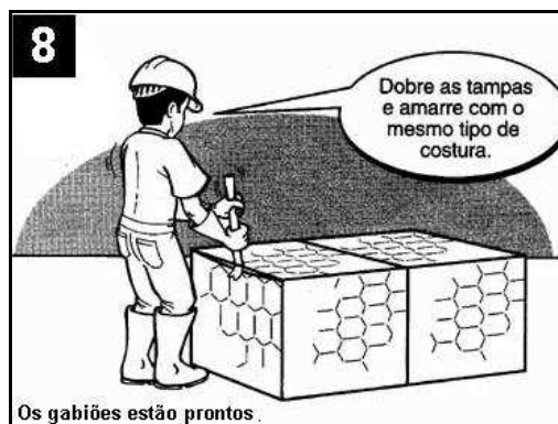
Figura 09 – Detalhe da etapa de fechamento do gabião tipo caixa.
