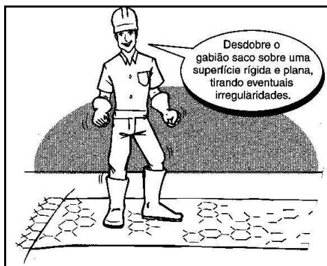
Figura 10 – Preparação de um gabião saco. Figura 11 – Detalhe da amarração de uma extremidade
