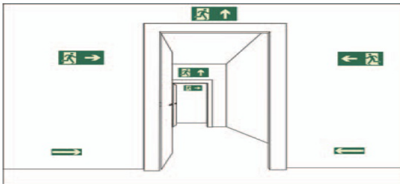
Figura 11 - Sinalização de saída sobre paredes e vergas de portas
