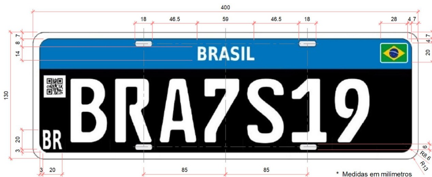
Figura 8 - Placas dos demais veículos de coleção classificados como originais, de uso restrito ao território nacional
